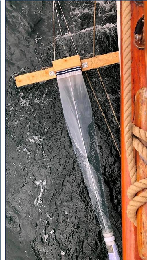
△ Links: Vorbereitung zum Hol – im Vordergrund ist der „Manta“ mit geöffnetem Maul zu erkennen, während an Deck noch die Halteleinen klariert werden. Rechts: Das Manta-Schleppnetz neben der Schiffswand in Aktion. Am dünnen Ende des Eigenbau-Gerätes ist der Sammelbehälter für die Proben des Oberflächenwassers zu erkennen.
